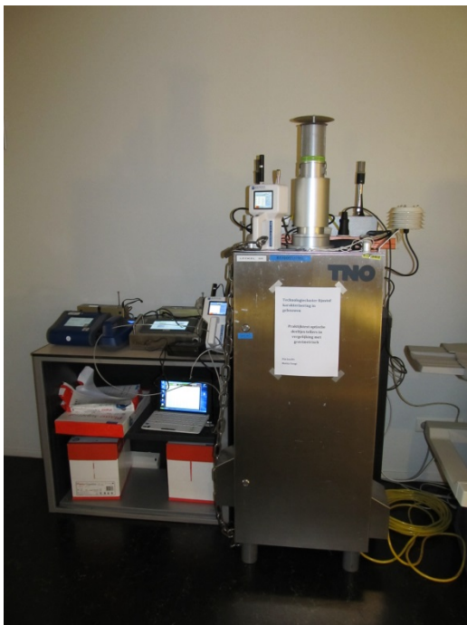
Figuur 2: links diverse typen optische deeltjes tellers en rechts een filterwisselaar voor de gravimetrische referentiemethode
